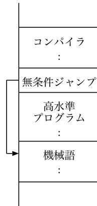
図 8.5 蓄積プログラム方式により、高水準プログラムを実行する概念図（コンパイラの実出力データだった機械語にジャンプし、それらを命令として実行する。）
