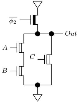
図 9 NOR(AND( $A, B$ ),  $C$ ) を出力するプリチャージ回路
