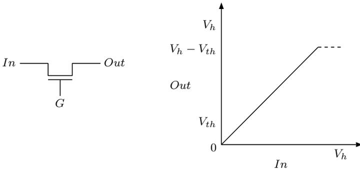
**図 5.5** n-MOS パストランジスタ (右図は  $G = V_h$  のときの入出力特性で入力  $V_h$  以下になると出力を  $V_h$  以上に持ち上げる能力が低下する。  $G = 0$  のときには完全に OFF)
