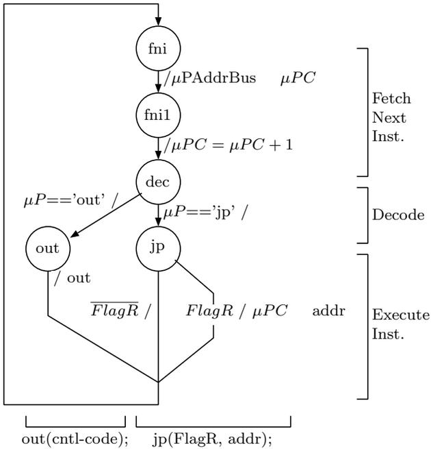
図 10.9 マイクロプログラム制御回路の状態遷移図（‘=’は代入，
