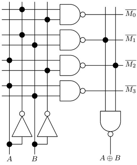
図5 EOR の NAND-NAND 回路 ( $\overline{M_0}$  と  $\overline{M_3}$  を作る回路は不要であるので、これらを消去すると、図1の下図と一致する)
