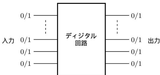
図 1.1 複数の 2 進信号線による入出力処理
