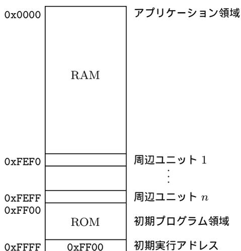
図 7.5 メモリー空間の割り当ての例 (0x0000 と 0xFFFF 以外は比較的自由に選べる)
