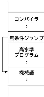
**図 8.5** 蓄積プログラム方式により、高水準プログラムを実行する概念図（コンパイラの出カデータだった機械語にジャンプし、それらを命令として実行する。）
