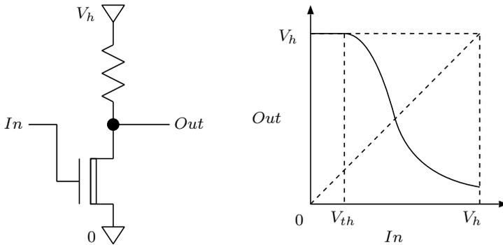
図 3.2 n-MOS を用いた NOT 回路とその入出力特性 (n-MOS の主回路を白く表現することにより,  $In = 0$  のとき OFF であることを示した)
