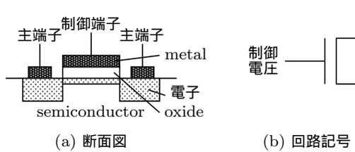
図 2.5 n-MOS FET の断面図と回路記号
