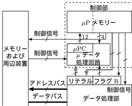
図 10.10 制御部のマイクロプログラム化
