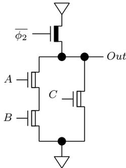
図.7 NOR(AND( $A, B$ ),  $C$ ) を出力するプリチャージ回路
