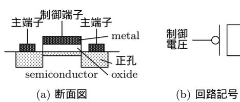
図 2.6 p-MOS FET の断面図と回路記号
