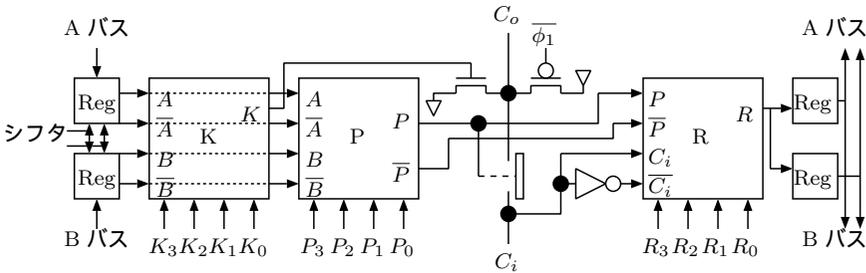
図 9.5 ALU(シフトから入る入力にはシフト結果とシフト量の選択が可。K と P の出力には  $\overline{\phi_1}$  との AND が入る。)
