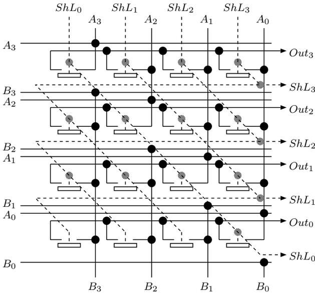
図 9.4 シフタ (見やすいように制御用関連の配線は破線で示した)
