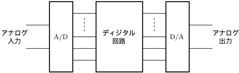
図 1.2 デジタル回路によるアナログ処理
