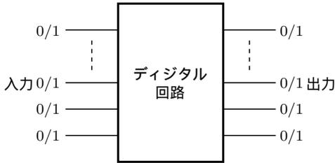
図 1.1 複数の 2 進信号線による入出力処理
