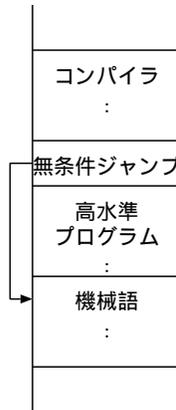
図 8.5 蓄積プログラム方式により，高水準プログラムを実行する概念図（コンパイラの実出力データだった機械語にジャンプし，それらを命令として実行する。）
