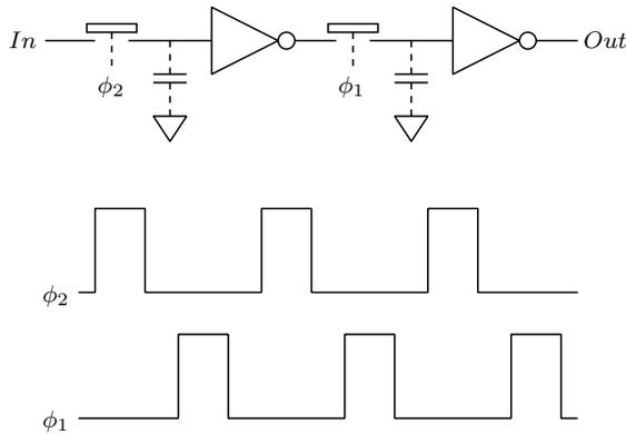
図 5.4 遅延回路 ( $\phi_1, \phi_2$  は二つのスイッチを開閉するための信号で、高いときに ON, 低いときに OFF となる)
