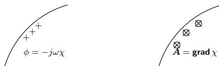
図 10.2 導体内のポテンシャル。電場と異なり、ポテンシャルは表面で連続でなければならない。面垂直方向の微分は表面で不連続となる。
