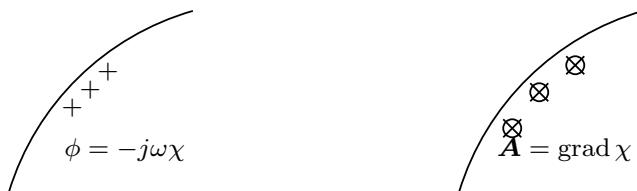
図 10.2 導体内的ポテンシャル。電場と異なり、ポテンシャルは表面で連続でなければならない。面垂直方向の微分は表面で不連続となる。
