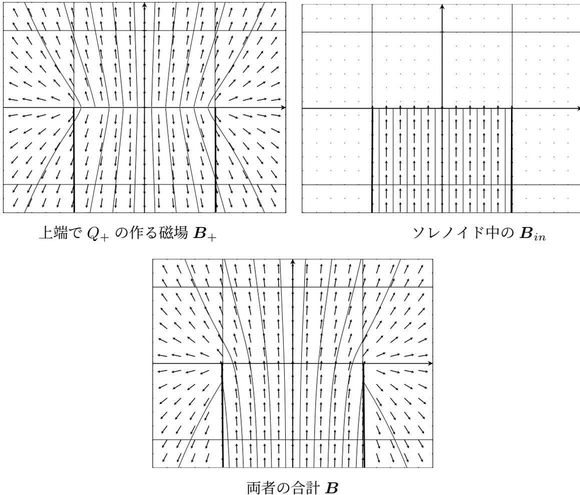
図 3.3 磁荷  $Q_+$  の作る左上の不連続な磁場  $B_+$  に右上の不連続な磁場  $B_{in}$  を加えると、下の連続な磁場  $B$  になる。
