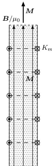
図 5.7 永久磁石の内部磁場は、磁化と同じ方向に発生する。
