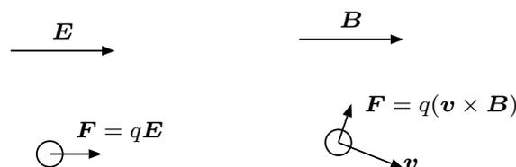
図 1.2 ローレンツ力: 静止している電荷は電場を、動いている電荷は加えて磁場を感じる。
