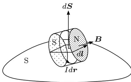
図 3.4 微小電流ループと閉曲面の交差。
