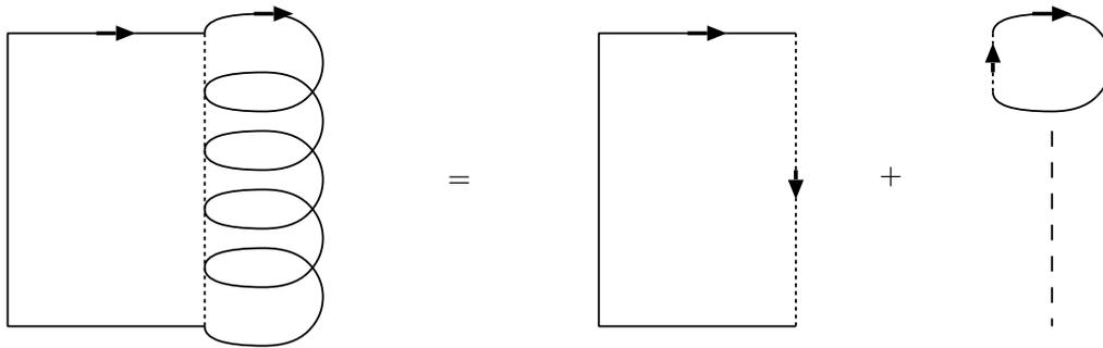
図 5.9 複数のコイルにより作られたソレノイドの分割。駆動電源が必要な場合は左の長方形のループ内に置かれる。
