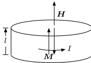
図 5.8 電流  $I$  の作る  $M = IS/V$ 。この大きさは  $M = I/l$  となる。
