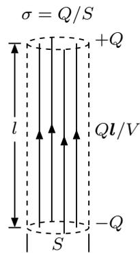
図 5.1 一つのミクロな電気モーメントに対する分極ベクトル。
