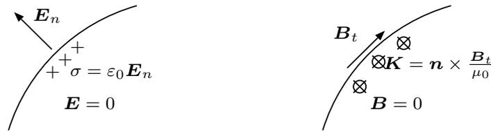
図 10.1 導体表面付近の電場と面電荷および磁場と面電流。厳密に静的な場合には  $B_0$  という固定磁場が追加される。
