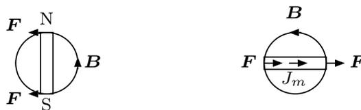
図 12.9 回転のある磁場中に置かれた上向きの磁化にかかる力。左: 棒磁石のように描いた磁荷分極モデル、右: 輪状のコイルのように描いた磁化電流モデル
